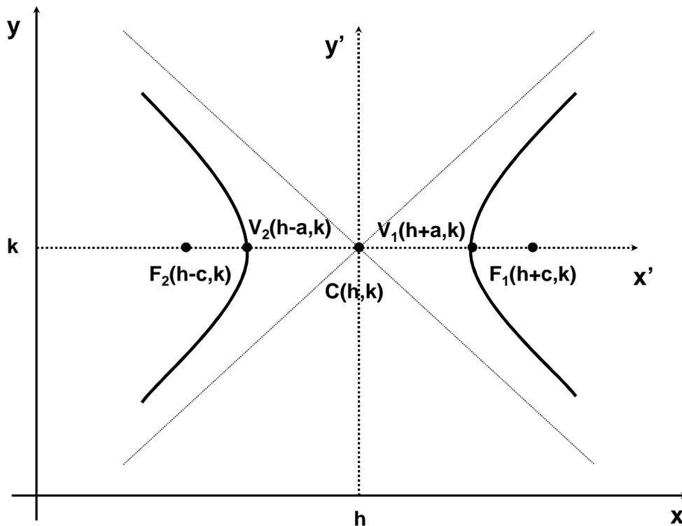
De la figura se puede apreciar que los vértices están en:  $V_1(h+a, k)$  y  $V_2(h-a, k)$ , los extremos del eje imaginario están en:  $B_1(h, k+b)$  y  $B_2(h, k-b)$ , por su parte, los focos se ubican en  $F_1(h+c, k)$  y  $F_2(h-c, k)$ . La longitud del lado recto sigue siendo  $LR = \frac{2b^2}{a}$ , los extremos de los lados rectos son:  $\left(h \pm c, k \pm \frac{b^2}{a}\right)$  y las ecuaciones de las asíntotas son:  $y - k = \pm \frac{b}{a}(x - h)$ .
