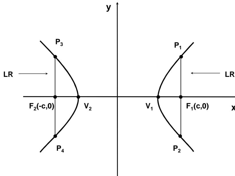
Para encontrar las coordenadas de los extremos del lado recto, que pasa por el foco  $F_1$ , se sustituye  $x$  por  $c$  en la ecuación despejada para  $y$ :
